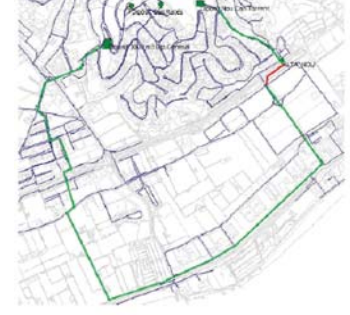
Figura 42. Connexió d'interconnexió dels Dipòsits Generals al Dipòsit Nou a través de la zona existent
