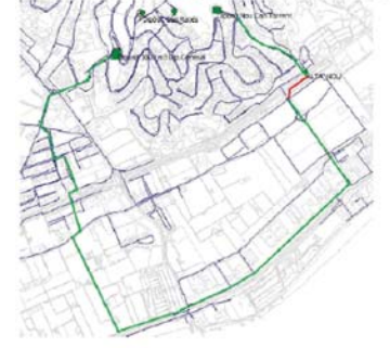
Figura 42. Creació d'interconnexió dels Dipòsits Generals i el Dipòsit Nou a través de la zona existent
