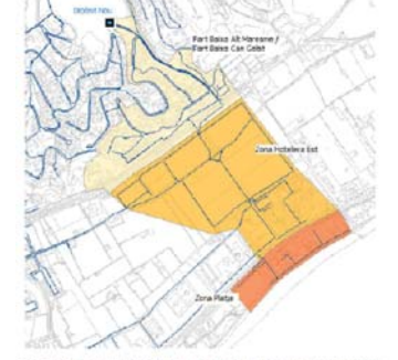
Figura 46. Pís de pressió del Dipòsit Nou i límit de zona horitzontal abastada des del Dipòsit Nou
