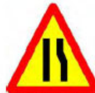
TP-17 a Estrenyiment de la calçada per la dreta
