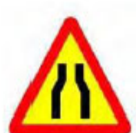
TP-17 Estrenyiment de la calçada
