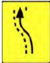
TS-60 Desviament d'un carril per calçada oposada
